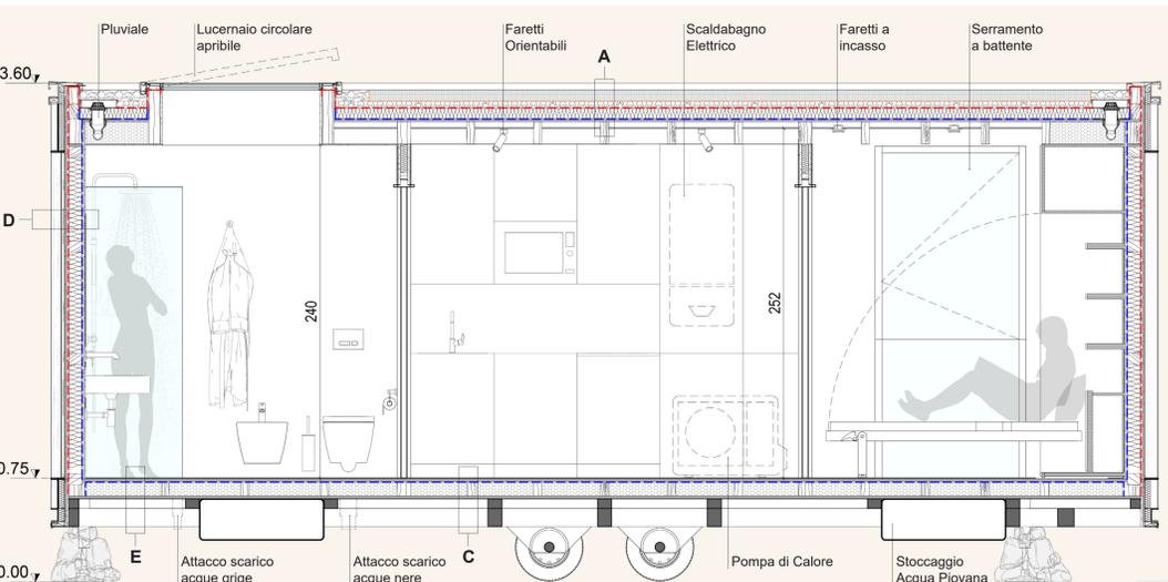
Sezione di Dettaglio Longitudinale - Scala 1:20
