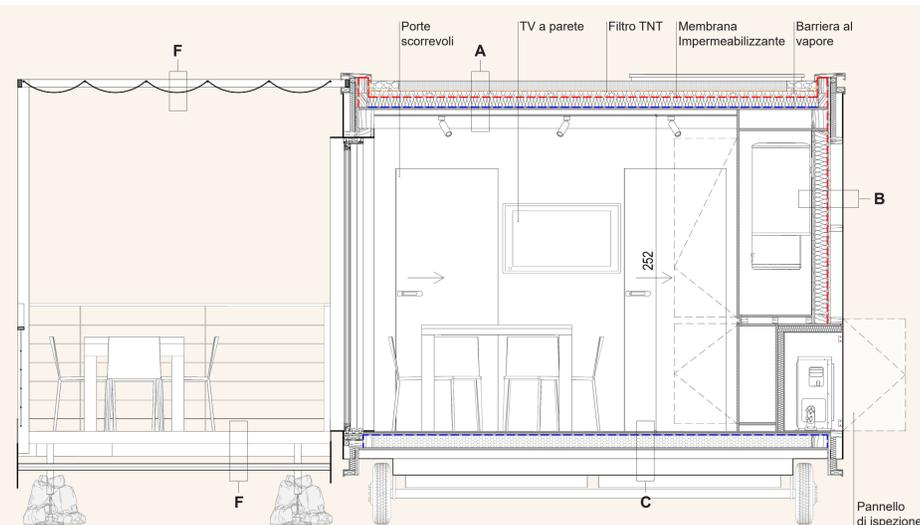
Sezione di Dettaglio Trasversale - Scala 1:20
